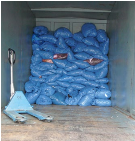
Die Ware hintereinander in Reihen stapeln und von hinten nach vorne stückweise treppenartig auffüllen.
